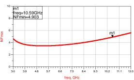
Fig. 9. NF\_min(dB) curve
